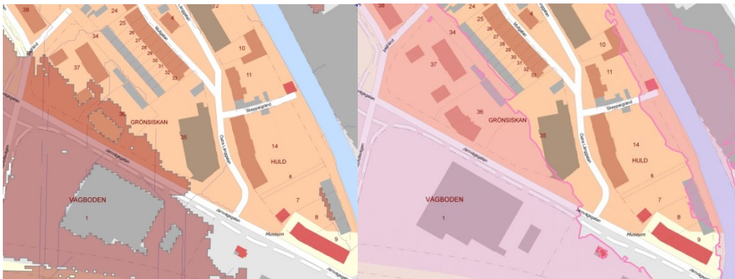
Risk för ansamling av vatten vid skyfall.
